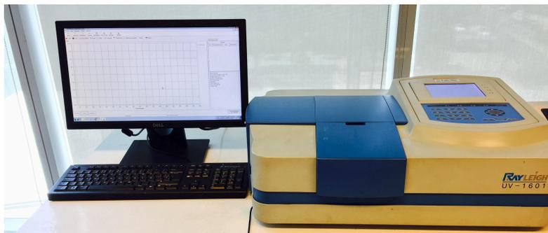
**Figura 27:** Espectroscómetro UV-visible Rayleigh 1601.
