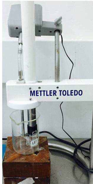
**Figura 28:** Montaje experimental para las pruebas realizadas con el equipo FBRM.
