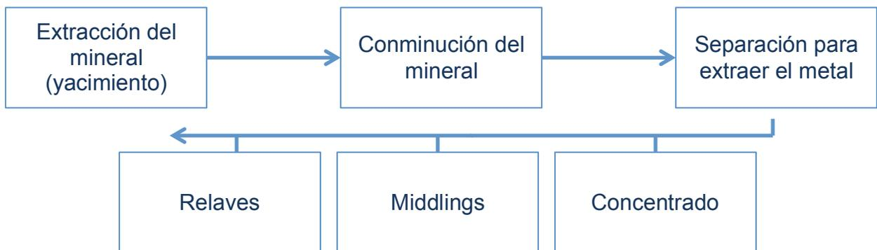
**Figura 1:** Diagrama de bloques simple del proceso productivo minero [4].
