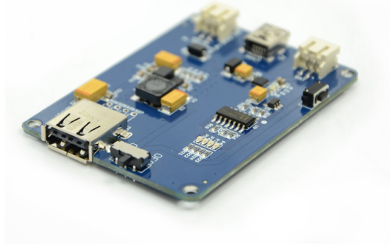
Figura 6.9: Lipo Rider Pro: Placa de administración de energía.
