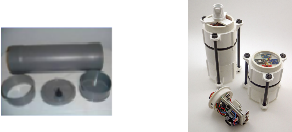
(a) Ejemplo de tubo PVC para prototipo actual (b) Ejemplo de proyecto de carcasas para dataloggers acuáticos
