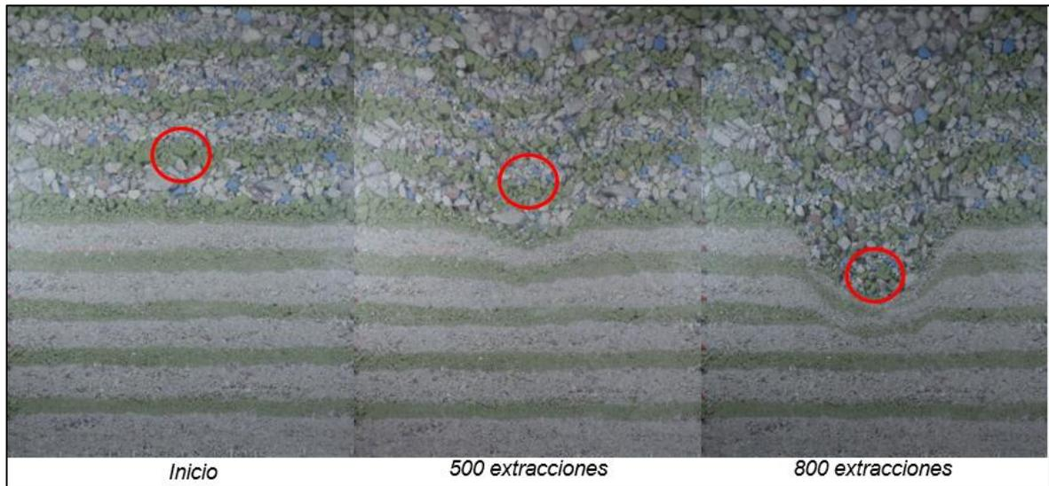
Figura 69 Evolución elipsoide de flujo, Experimento socavación 20 m
