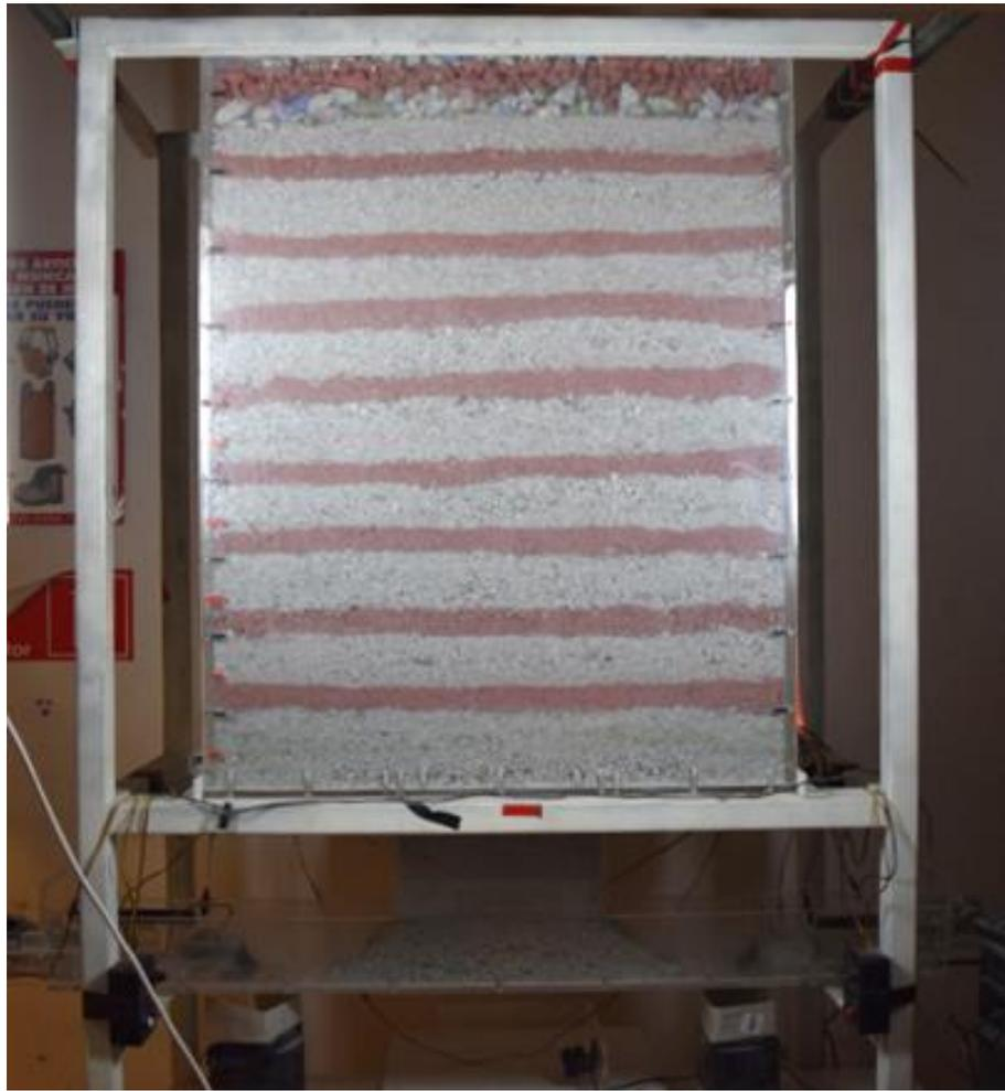
Figura 67 Montaje experimento altura de socavación 40 m
