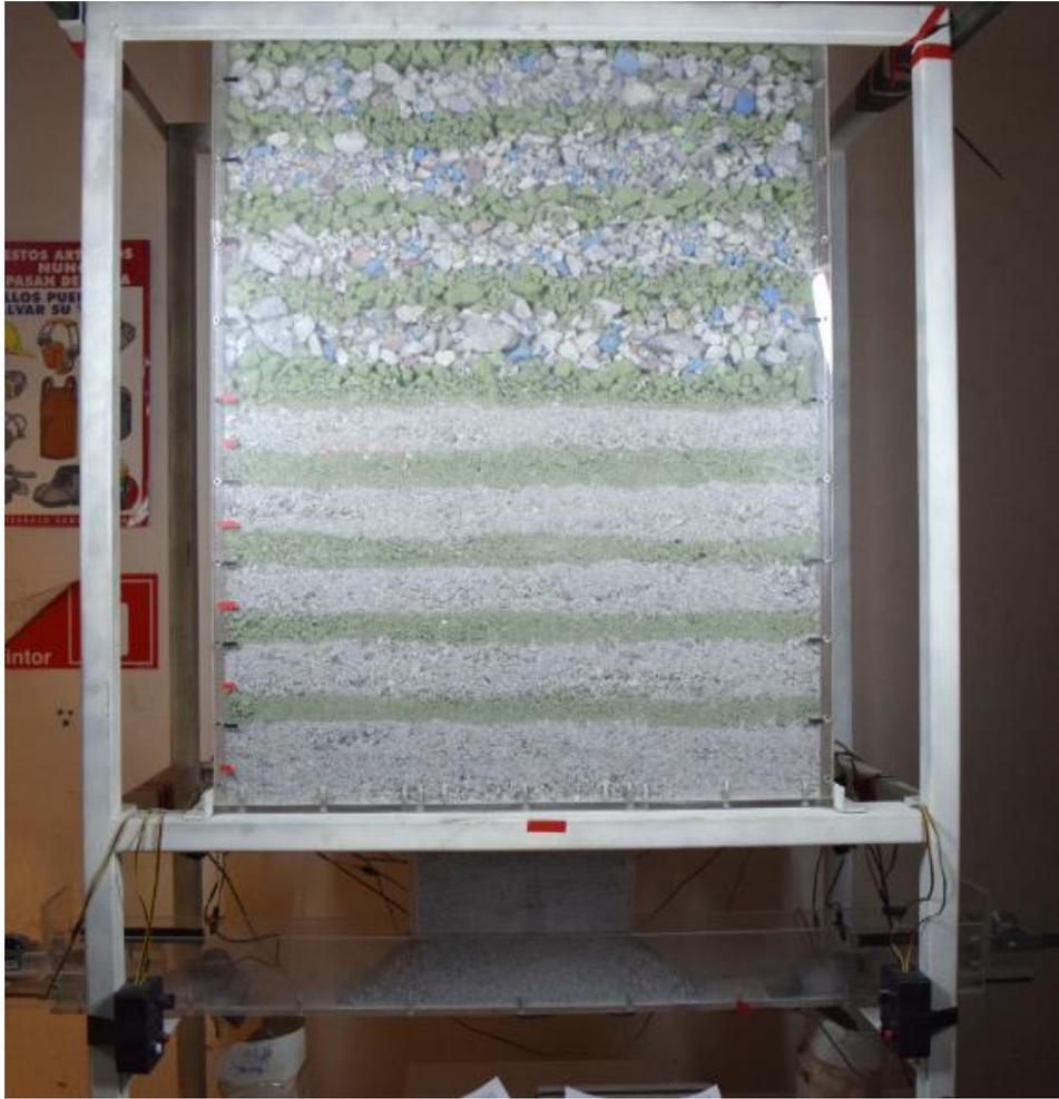
*Figura 66 Montaje experimento altura de socavación 20 m*
