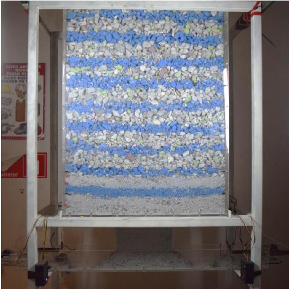
*Figura 65 Montaje experimento altura de socavación 4 m*
