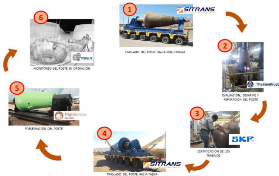
Figura 1. Proceso actual de reparación de postes de Chancadores de División Radomiro Tomic
