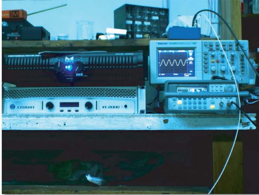
Figura 3.3: En la fotografía se observa el amplificador de audio, generador de señales, osciloscopio y el acelerómetro.
