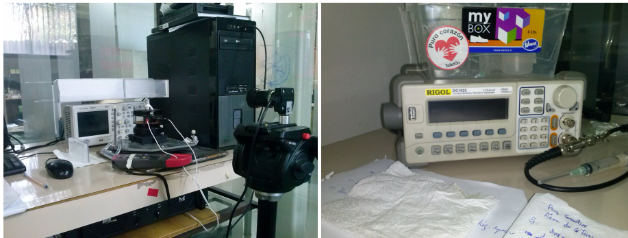
Figura 2.8: Izquierda: Celda montada sobre vibrador, detrás de ella está el osciloscopio y frente a ella la cámara; Derecha: Generador de funciones.
