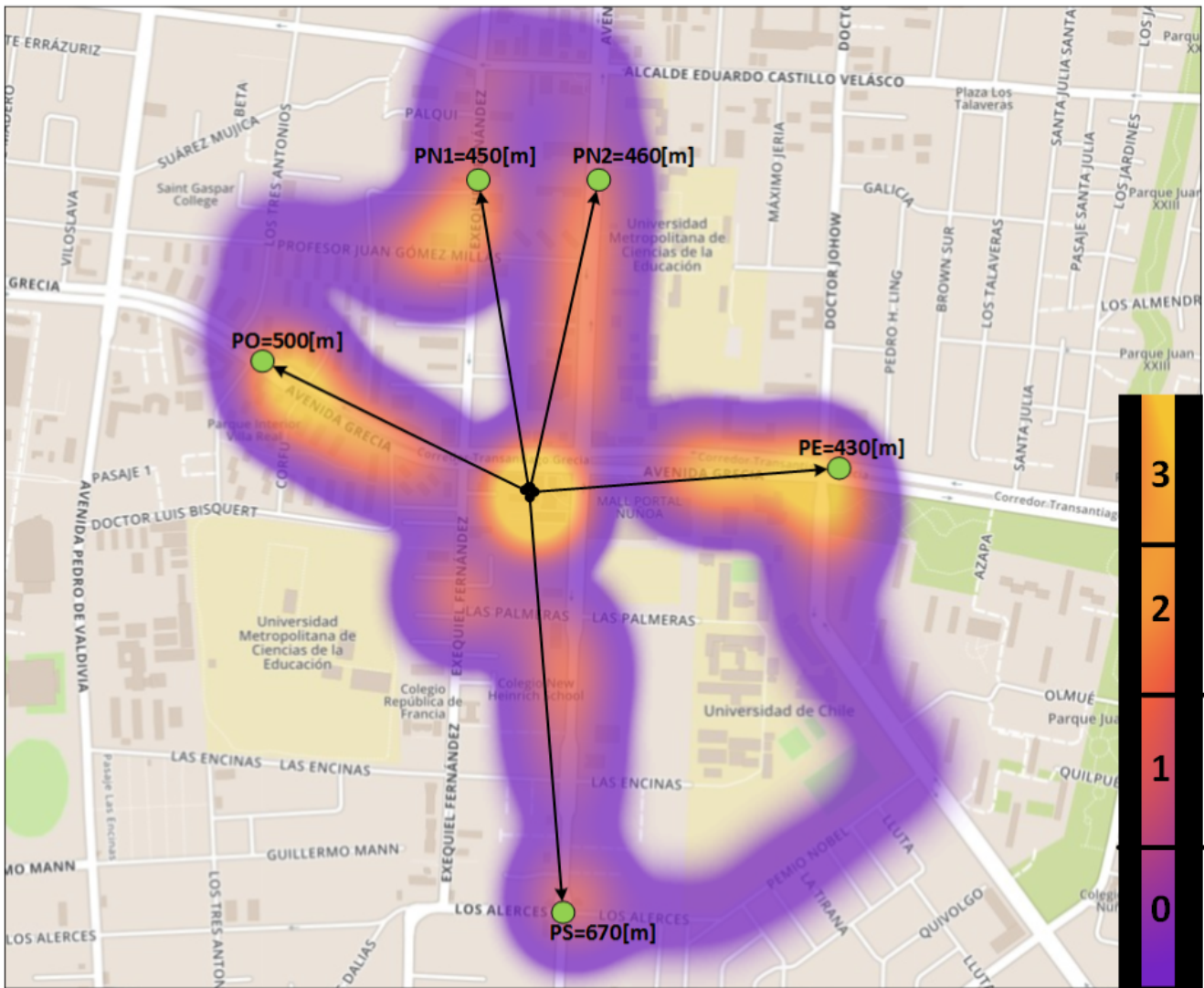
Figura 4.11: Heatmap de comunicación LoRa Prueba 2.
