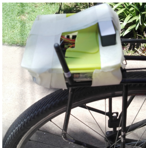
Figura 3.5: End-device montado en bicicleta.
