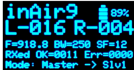
Figura 2.3: Ejemplo de pantalla principal del nodo en estado “master”.
