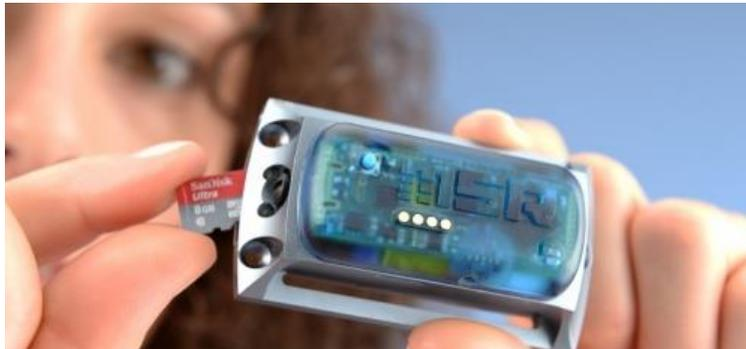
SHOCK 101 y SHOCK 101 EB. Registrador de impacto de aceleración máxima en los 3 ejes (-50G a + 50G).
