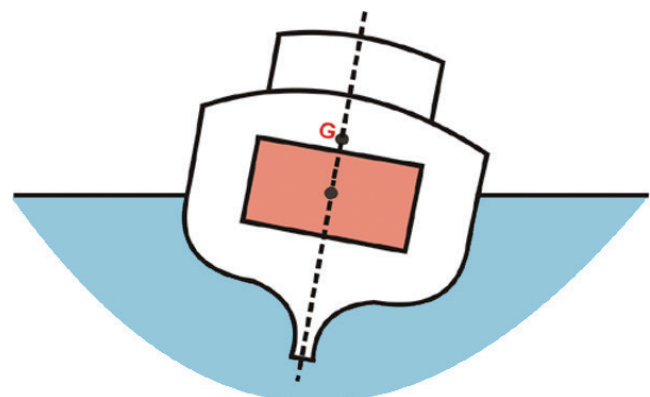
Estanque lleno: no hay cambio en el centro de gravedad.
