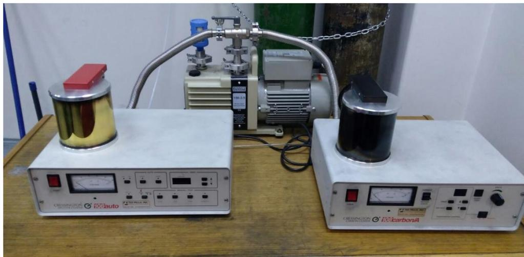
Figura 2.8 Equipo Cressington Sputter Coater 108/108auto, a la derecha para el metalizado con Carbono y a la Izquierda para metalizado con oro, en dependencias del Departamento de Geología de la Universidad de Chile.
