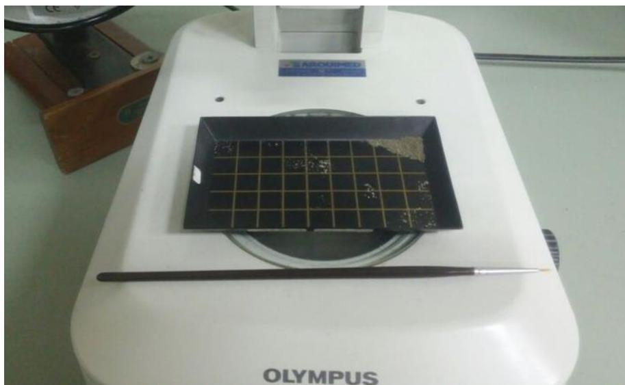
**Figura 2.5 Lupa Binocular electrónica OLYMPUS, bandeja de recolección de foraminíferos y pincel delgado para separación, materiales utilizados en el Laboratorio de Sedimentología del Departamento de Geología de la Universidad de Chile. Muestra en proceso de separación.**
