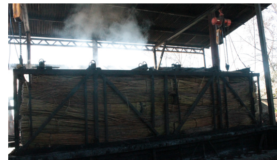
Varas antes de meterlas en la tina de agua Fuente: Archivo Personal
