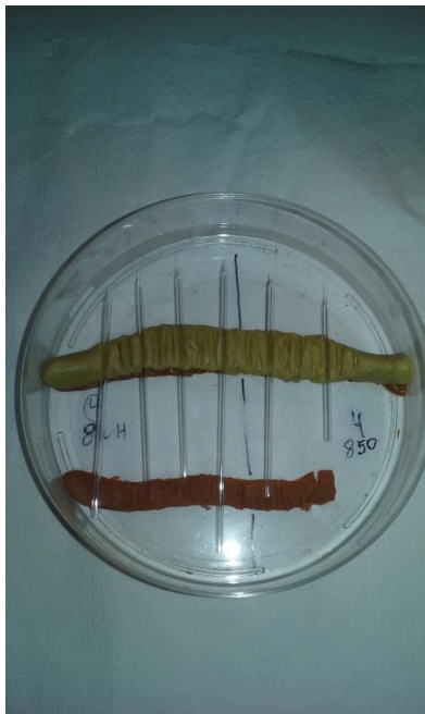
Fotografía 5: Microelectrodos utilizados en los experimentos de “Potencial controlado en célula completa”.
