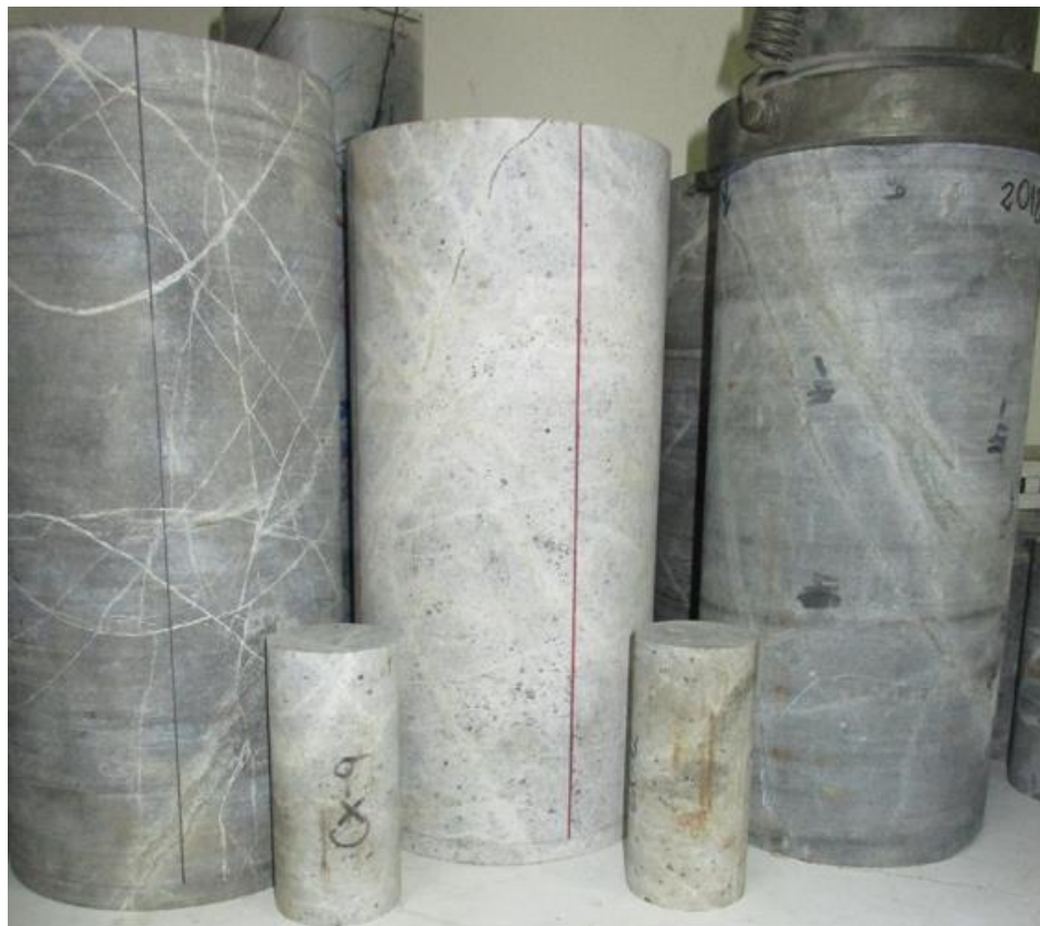
Figura 16: Algunas de las muestras probadas. Las más oscuras a la derecha e izquierda corresponden a litología CMET, mientras que la del medio es dacita.
