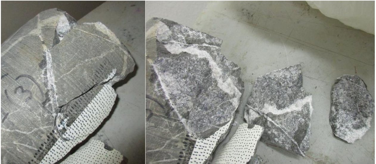
Figura 56: cara interior con fragmentos unidos y separados, mostrando matriz.
