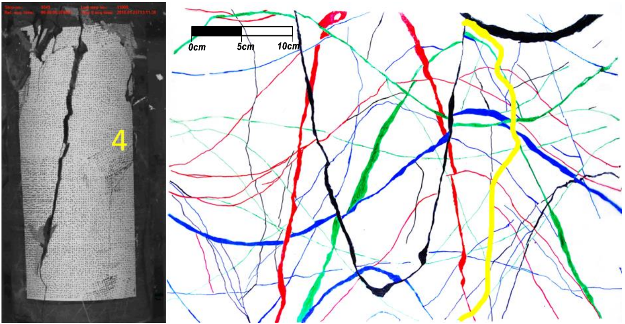
Figura 61: Cuarta fractura y su traza marcada en amarillo.
