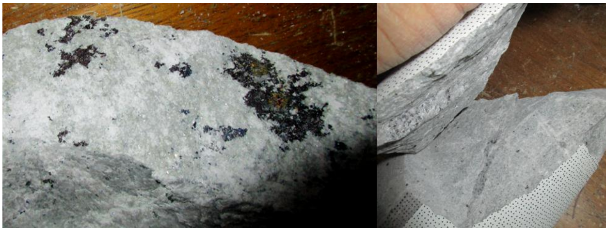
Figura 36: A la izquierda una foto del relleno de la vetilla que participó en la fractura. A la derecha el segmento de la matriz.
