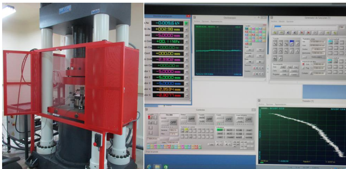
Figura 22: Prensa Servosis para ensayos de compresión y computador de monitoreo.
