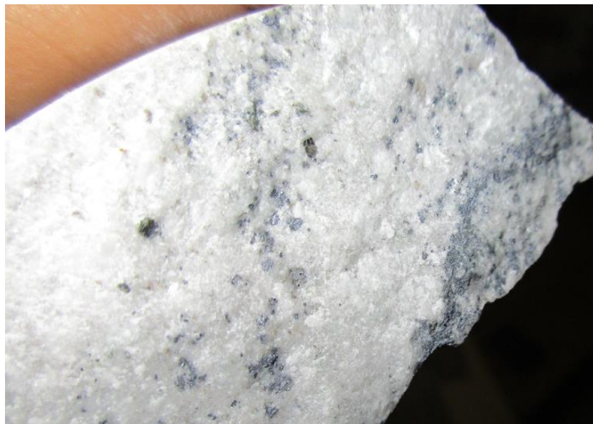
Figura 39: Lo blanco apreciado en la vetilla es cuarzo, mientras que lo grisáceo corresponde a molibdenita.
