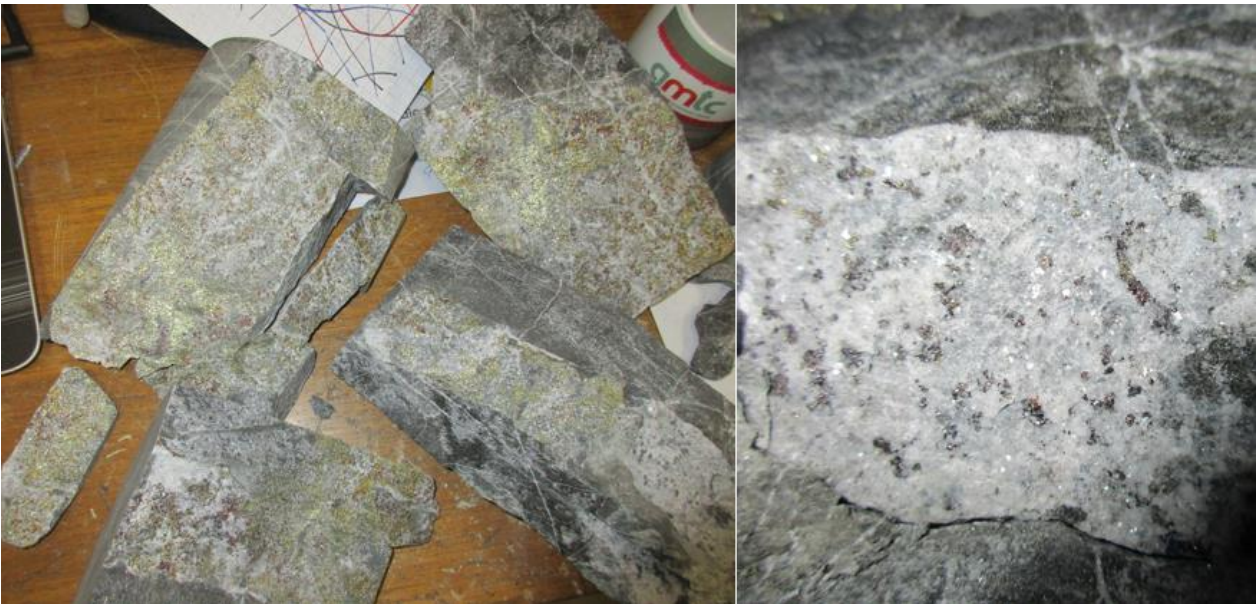
Figura 71: Fotos mostrando las últimas fracturas internas en vetillas con minerales blandos.
