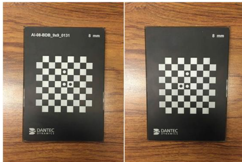
Figura 13: Tablero de calibración para cámaras DantecDynamics.
