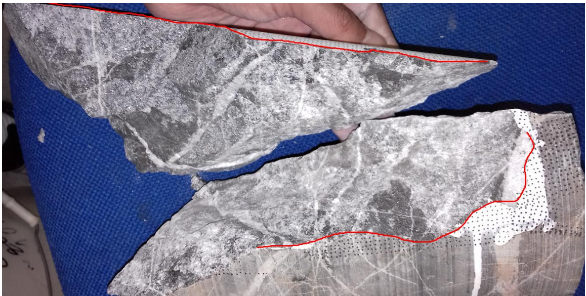
Figura 62: Marcado en rojo el camino el borde de la fractura. Se pueden ver caras mineralizadas principalmente con cuarzo y anhídrita.
