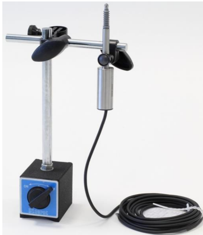
Figura 2: Tipo de LVDT usado en este proyecto.
