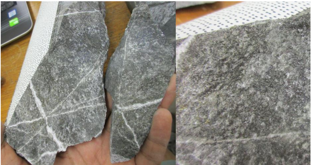
Figura 66: Fractura mencionada anteriormente, exponiendo matriz.
