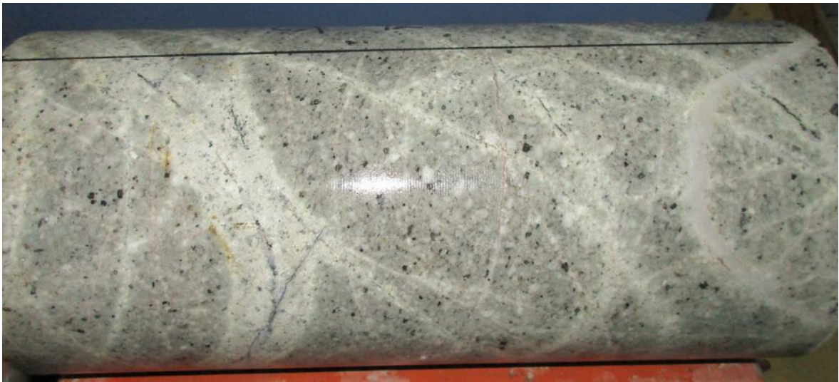
Figura 4: Muestra de tipo dacita usada en este trabajo (PDAC).
