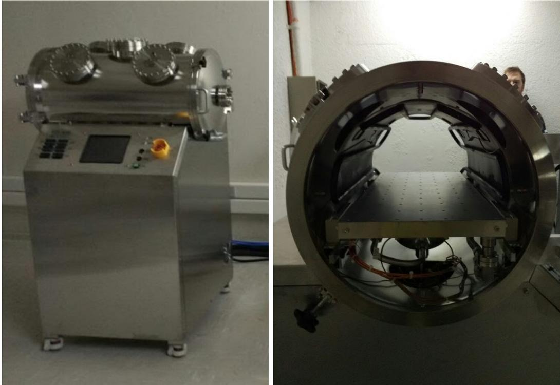
Figura 3.17: Cámara de pruebas *NDT-4000*.
