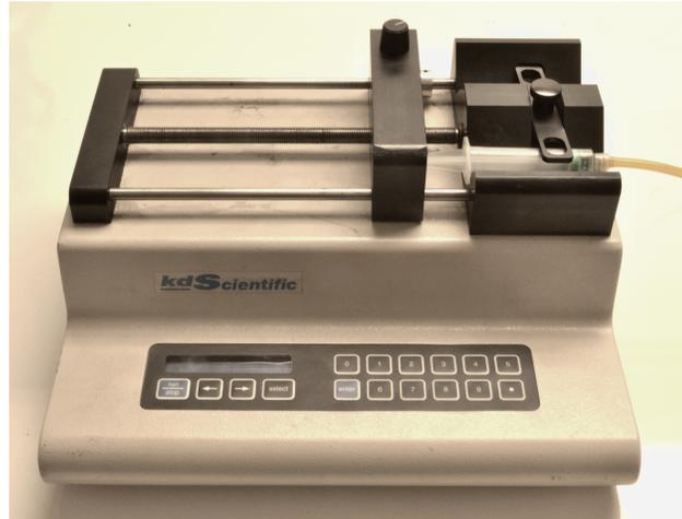
Figura 3.9: Bomba de infusión KDS-200, con aplicación en microfluídica. Sus características se detallan en 3.5.
