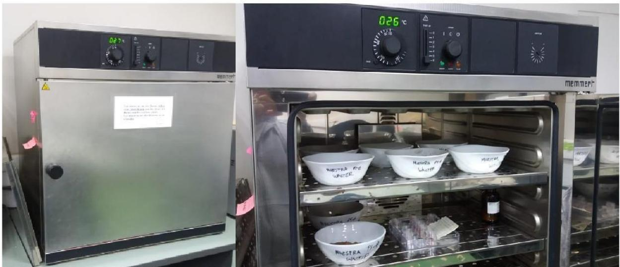
Figura 7.16: Implementos utilizados en proceso de secado de muestras. A la izquierda se observa el horno marca Memmert utilizado, a una temperatura aproximada de 27°C. A la derecha se observan las muestras de unos 150 gr aproximadamente de peso. Las muestras han sido etiquetadas previamente, registrando el código de la muestra.
