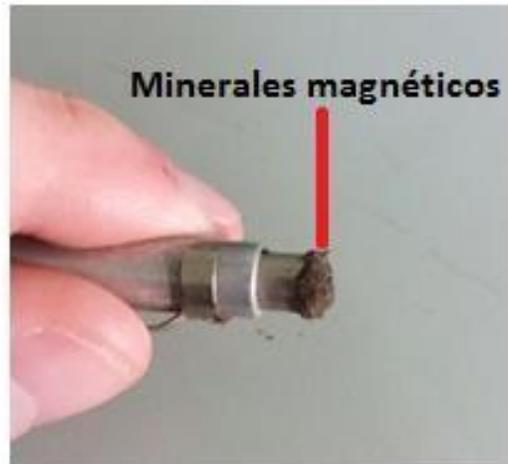
*Figura 2.21: Aplicación de un imán sobre las muestras de suelo.*
