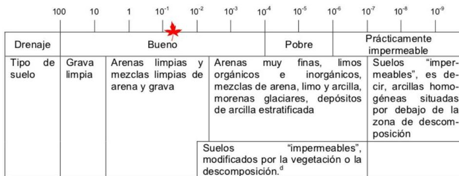
Figura 4.21: Coeficiente de permeabilidad de diferentes tipos de suelo. La marca de color rojo marca el punto donde aproximadamente caen la mayoría de las muestras de este estudio, suelos de buena permeabilidad, aunque el tamaño de grano más adecuado sería arenas finas con mezcla de limos y arcilla orgánicos.
