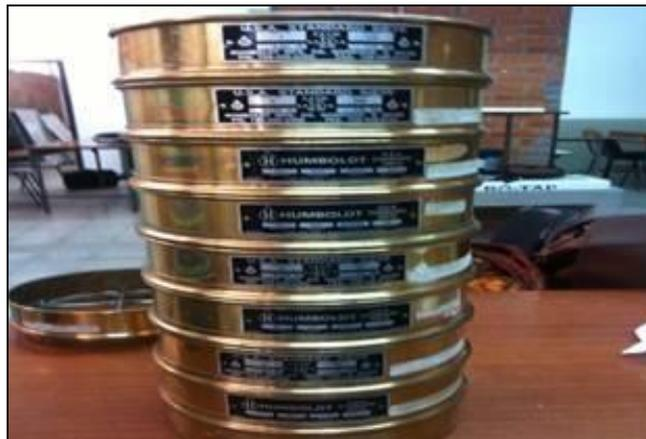
Figura 2.18: Mallas utilizadas para análisis de tamaño de partículas por la técnica del tamizado.
