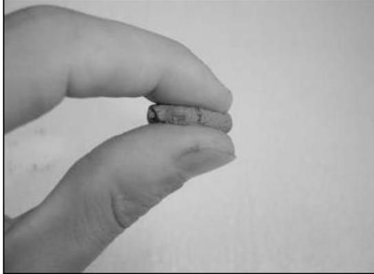
Figura 2.20: Análisis de consistencia de agregados de suelo, en la imagen se puede apreciar cómo se trata de desmenuzar el suelo entre los dedos índice y pulgar.
