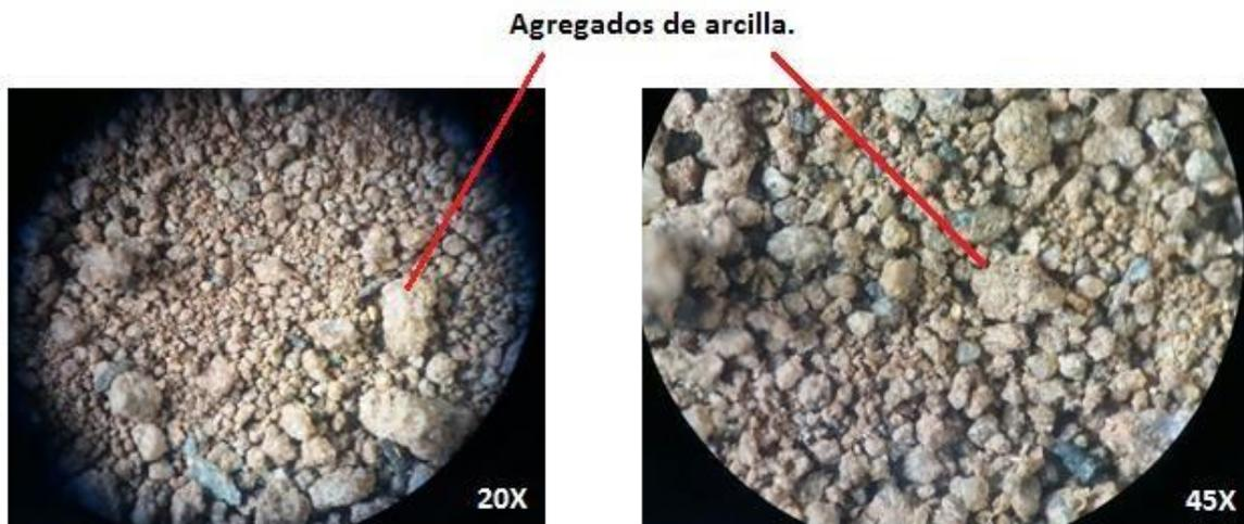
Figura 7.10: Muestra en profundidad severidad alta de incendio con aumento de 20X (izquierda) y 45X (derecha). Se notan la forma angulosa de los clastos de arcilla y cuarzo principalmente.
