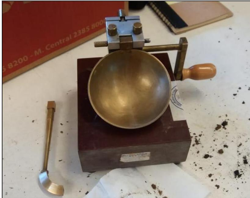
Figura 2.15: Máquina de Casagrande empleada para determinar el límite líquido.
