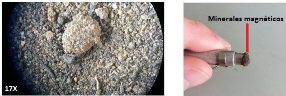
Figura 7.6: Muestra superficial severidad intermedia con aumento de 17X donde se aprecian los escasos agregados presentes (izquierda). Mientras que la imagen derecha ilustra la presencia de minerales magnéticos del suelo estudiado.
