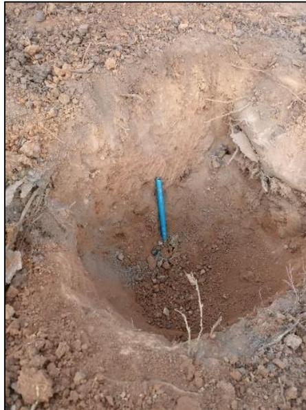
Figura 2.5: Ilustración de una calicata en terreno, de unos 20 cm de profundidad aproximadamente.
