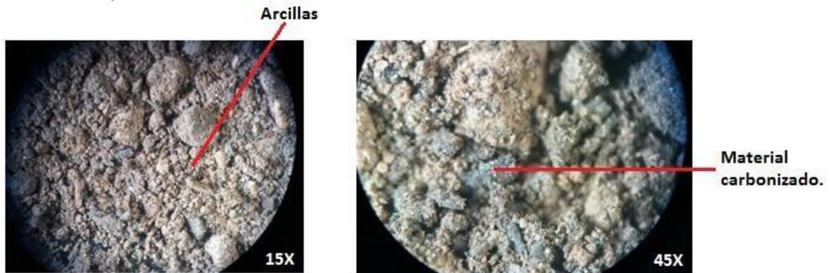
Figura 4.15: Muestra superficial severidad alta de incendio con aumento de 15X (izquierda) y 45X (derecha), Se puede observar la forma irregular de los granos y como la arcilla se une a las partículas de mayor envergadura.
