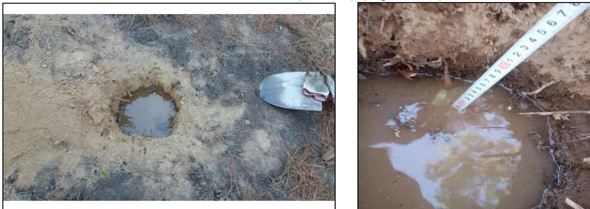
Figura 2.6: Ensayo de permeabilidad llevado a cabo en terreno. La idea era saturar el suelo de agua, una vez hecho esto, se medía cuánto había descendido el nivel del líquido (foto derecha) en un tiempo de 20 min y se volvía a rellenar con agua y se repetía el proceso hasta obtener la misma medición 3 veces.
