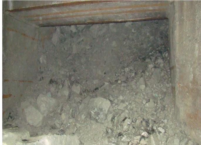
Figura 91: Punto de extracción en estado seco (H=0).
