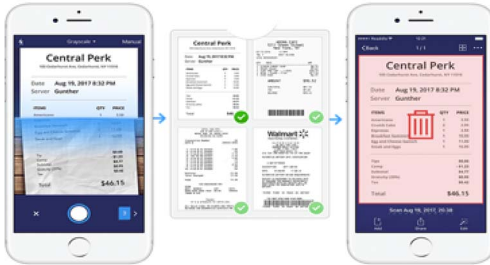
Figura 17: Ejemplo del Funcionamiento de la Tecnología OCR. Fuente: Elaboración Propia.
