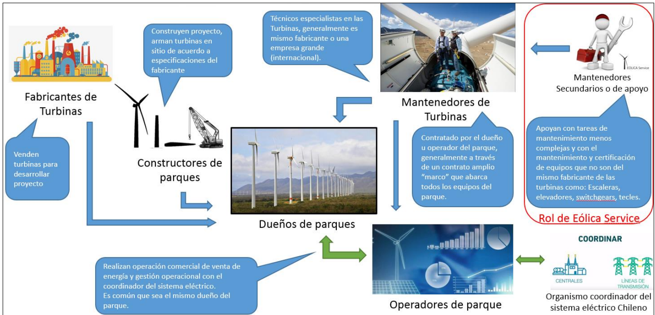
Figura N°2: Esquema de los principales participantes y su rol dentro de la industria de O&M de parques Eólicos en Chile.
