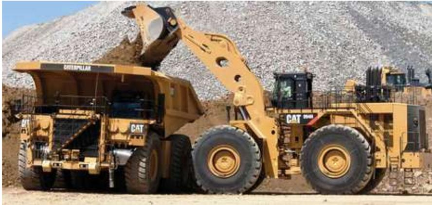
Figura 1.3: Cargador frontal cargando de material a camión de series Caterpillar en faena.
