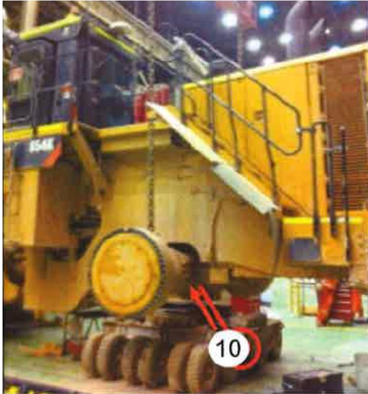
Figura 1.11: Proceso de descenso del eje trasero hacia la plataforma montada sobre neumáticos.
