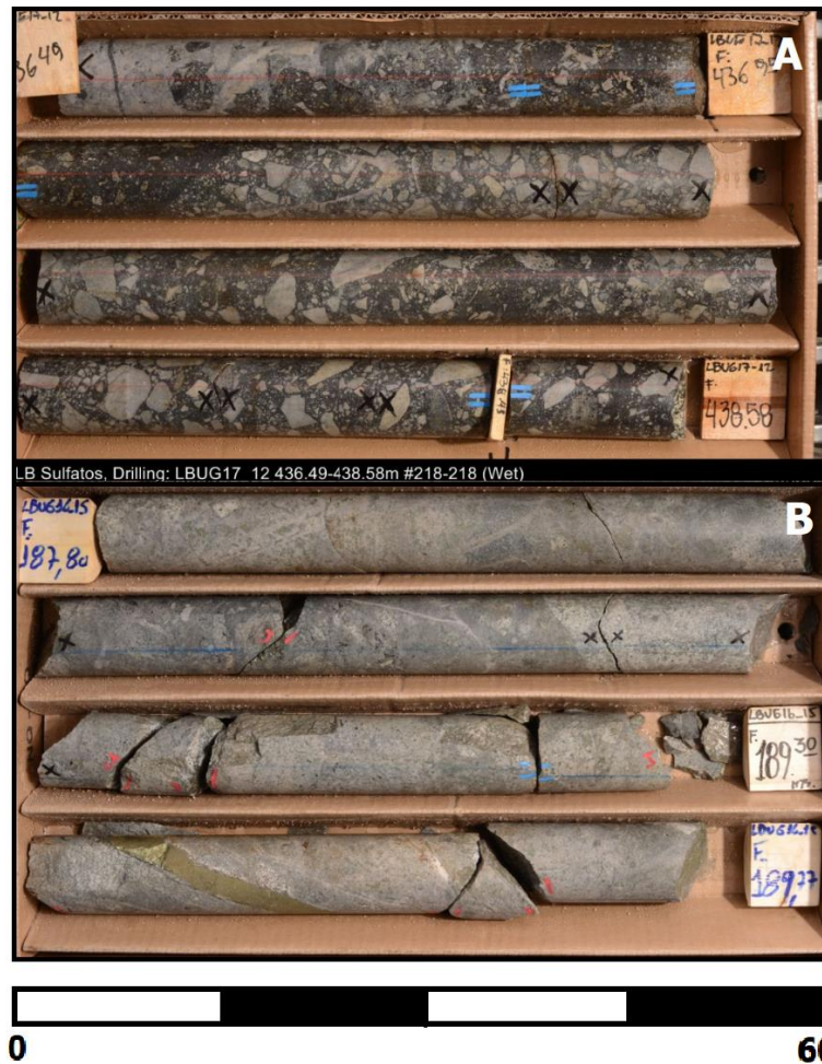
Figura 3.7: A) Litología BXT perteneciente al sondaje LBUG17_12 desde 436.49 a 438.58 m; B) Litología BXPR perteneciente al sondaje LBUG16_15 desde 187.80 a 189.77 m.
