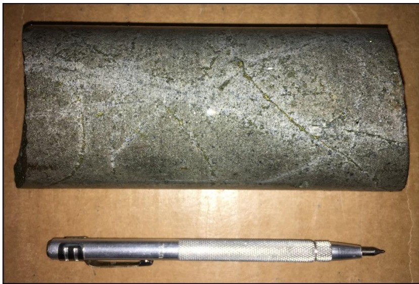
Figura 4.15: LBUG15_02 desde 245 hasta 260 m. Andesita de alta dureza con un grado de alteración sericítico alto con SPI=233.
