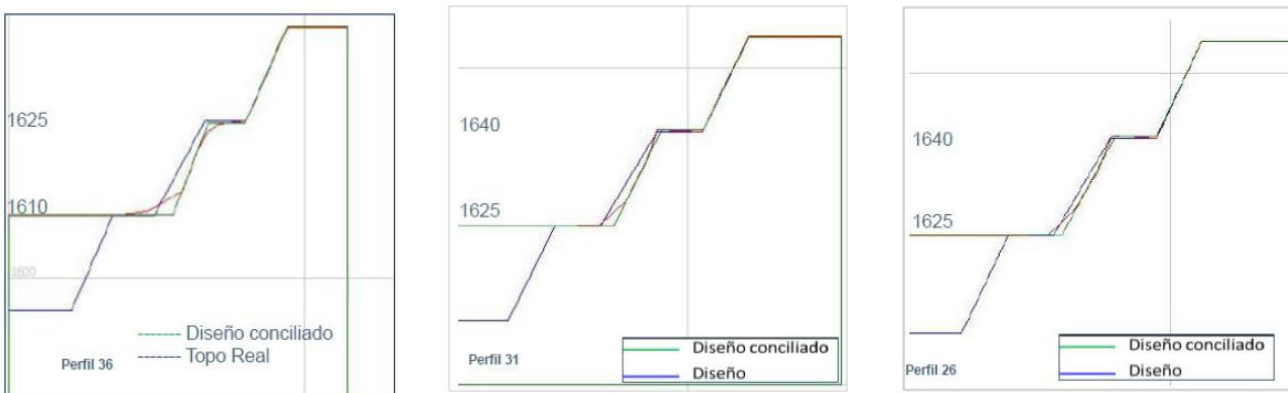
Ilustración 29: Perfiles de patios que han presentado deslizamientos post-tronadura.
