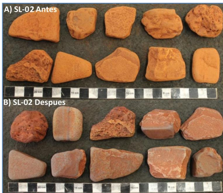
Ilustración 3.34. Slake, Antes (A) y después (B), muestra SL-02.
