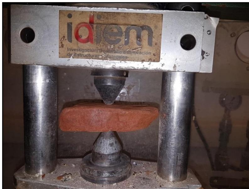
**Ilustración 3.18. Ensayo carga puntual perpendicular a las bandas, muestra A12.**
