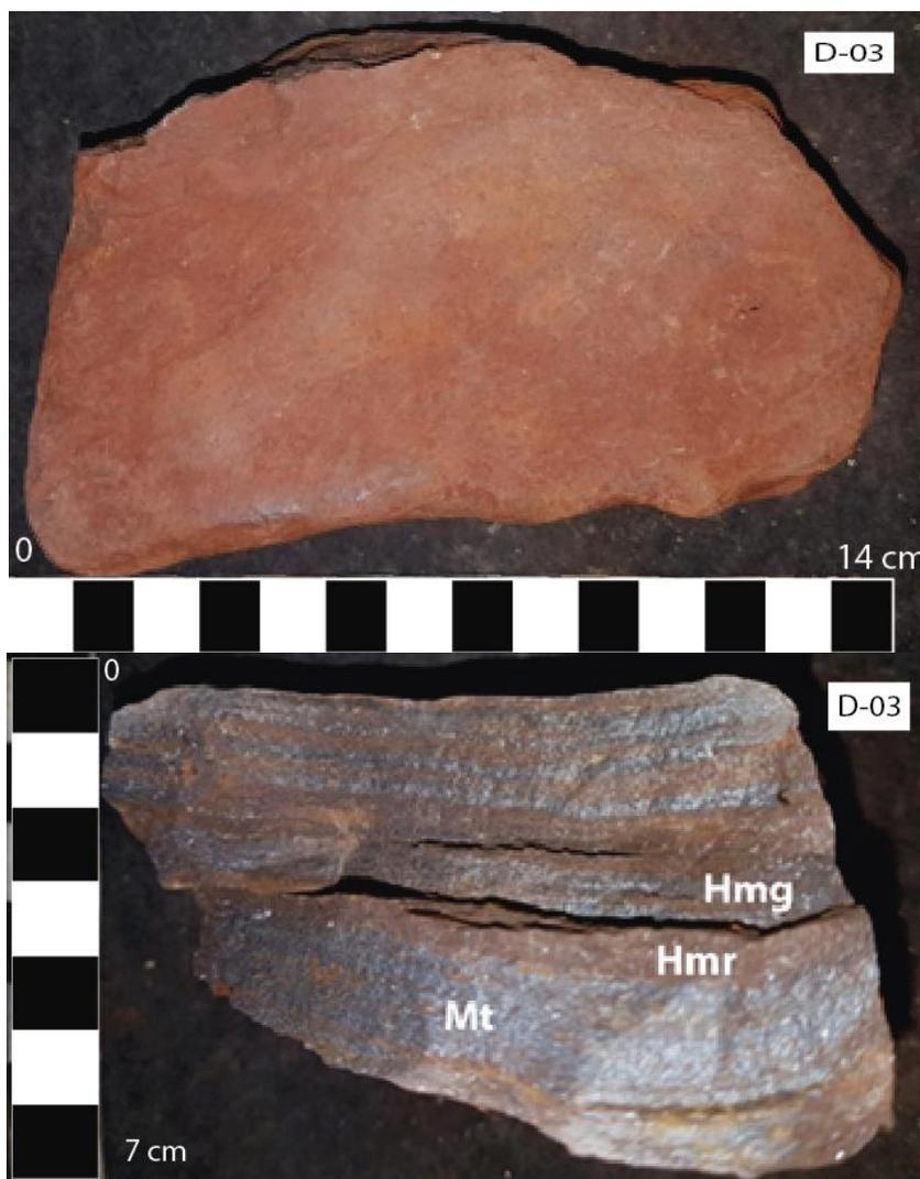
Ilustración 3.22 Roca D-03 y su corte transversal.
