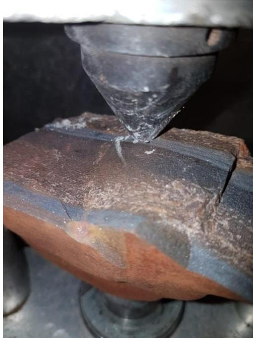
Ilustración 3.31 Carga puntual en banda de magnetita.
