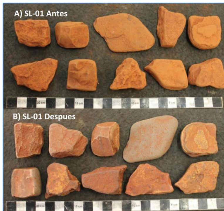
Ilustración 3.33. Slake, Antes (A) y después (B), muestra SL-01.
