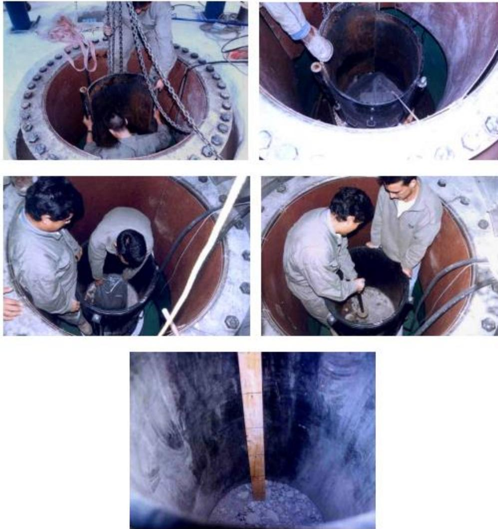
**Ilustración 1.2** Secuencia de armado de probeta triaxial gigante en IDIEM. Extraída de De la Hoz (2007).
