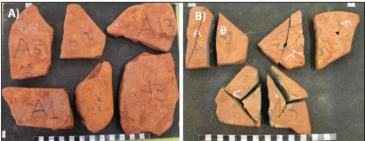
Ilustración 3.19. Foto carga puntual antes (A) y después (B) donde se observa como las rocas fallan por matriz.
