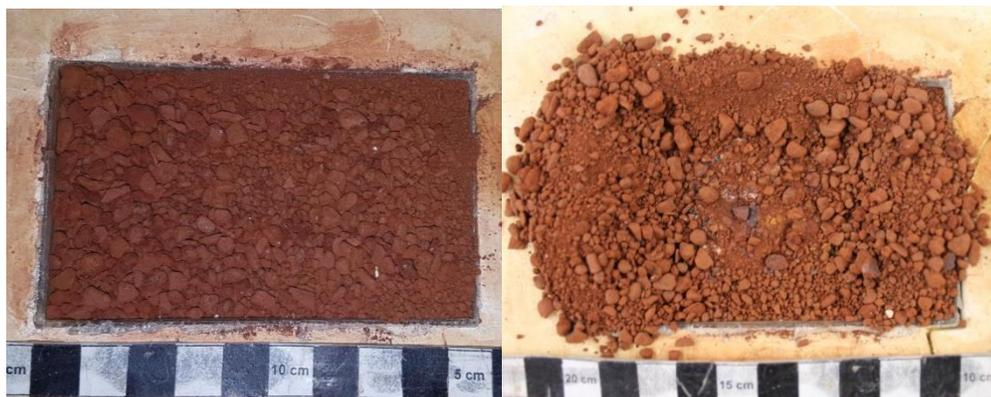
Ilustración 3.12 Foto antes y después de ensayar suelo a  $2,34\%$
