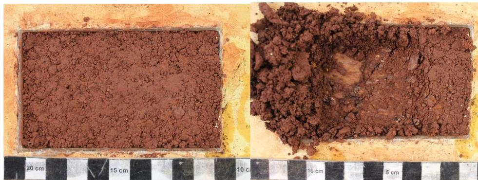
**Ilustración 3.16 Antes y después roca-suelo humedad al 8%**
