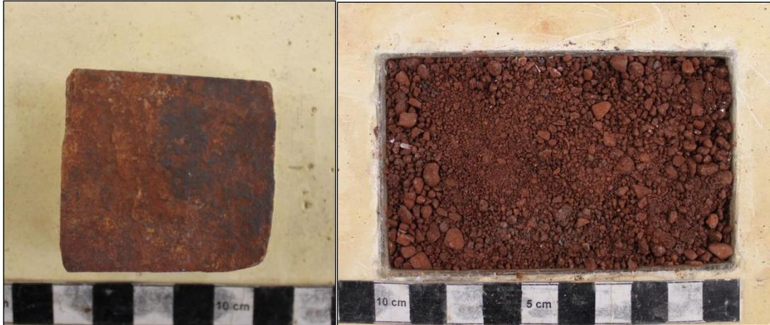
Ilustración 3.11 Foto que muestra la roca y celda para ensayar suelo.
