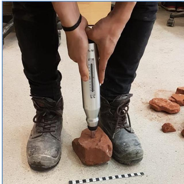
Ilustración 3.30. Utilizando el martillo de Schmidt, muestra D-07.
