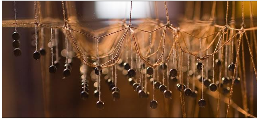
Figura 3. Acercamiento de modelo de cuerdas y pesos. En la imagen se observan las formas que adoptan acorde a las cargas solicitadas. (Memetican 2007).
