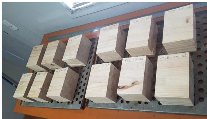
Figura 34. mini-muestras de MLE antes de ingresar al horno de secado.
