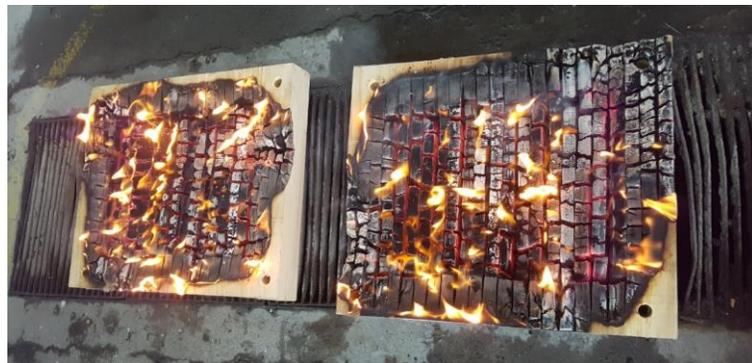
Figura 45. Probetas recién sacadas del horno con llamas presentes.
