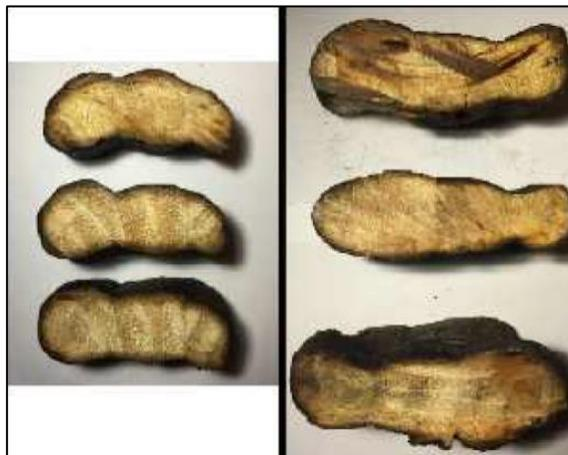
Figura 10. Muestras utilizadas para la medición del ancho residual, Ramírez (2001)
