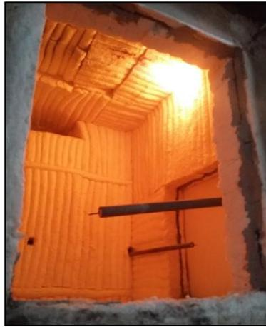
Figura 17. Cámara de combustión con llama
