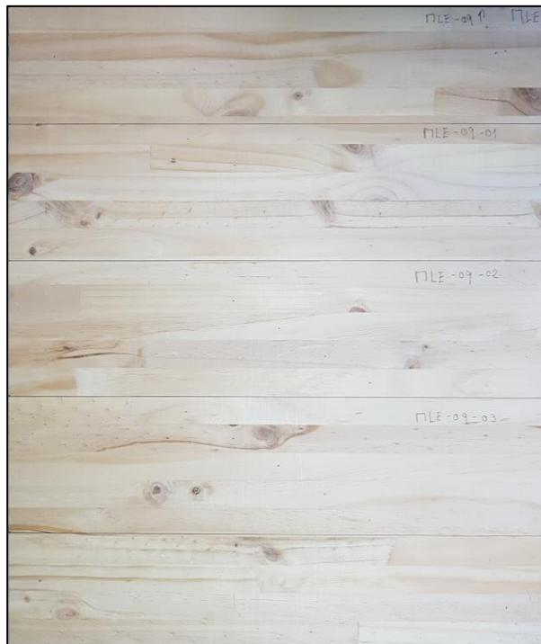
Figura 33. Probetas de MLE, con sus divisiones predeterminadas para el estudio previo
