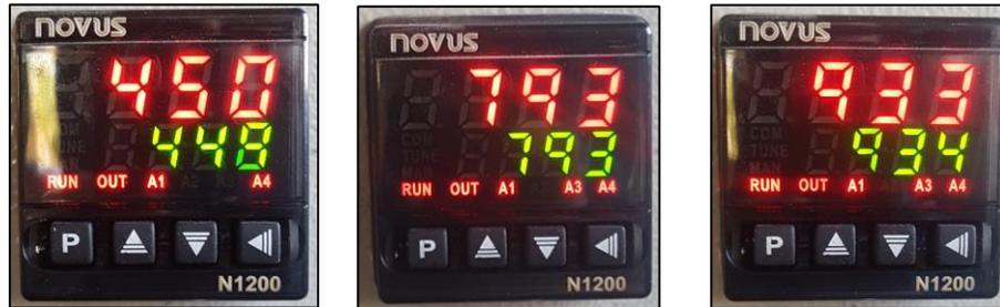
Figura 44. Seguimiento de Controlador N1200 de la curva tiempo-temperatura, Arriba T° deseada, Abajo T° real
