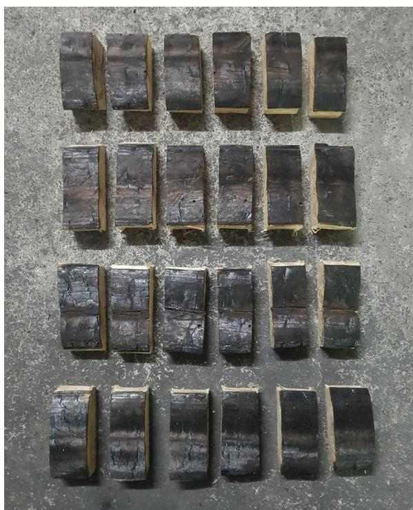
Figura 54. Mini-muestras para el cálculo del ancho residual
