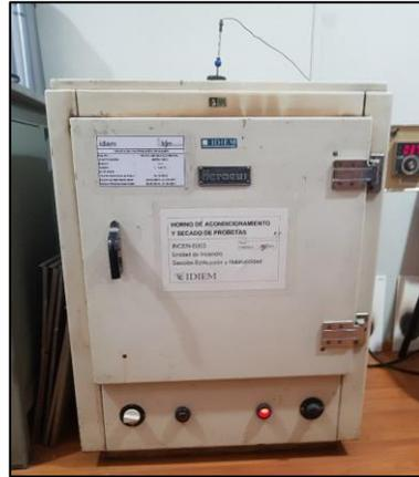
Figura 24. Horno de secado
