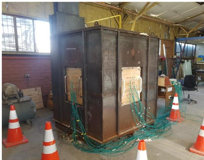
Figura 12. Horno de dimensiones reducidas, de izquierda a derecha, ventana 2 y ventana 1 respectivamente
