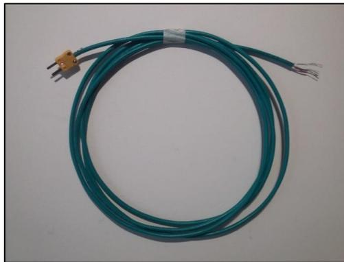
Figura 22. Cable Compensado
