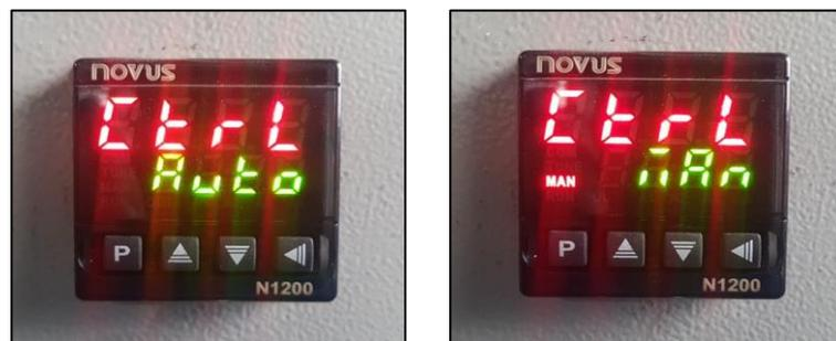
Figura 43. Controlador N1200 en automático y manual
