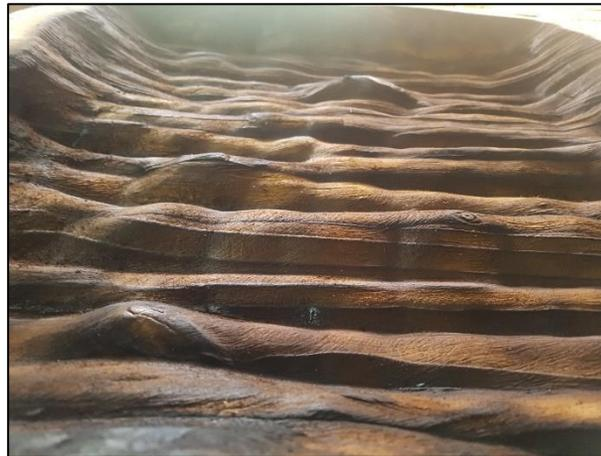
Figura 57. Irregularidades en la carbonización de probetas de MLE
