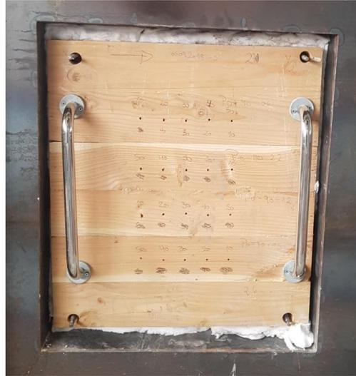
Figura 42. Probeta con protección de manta en los espacios entre horno y probeta.
