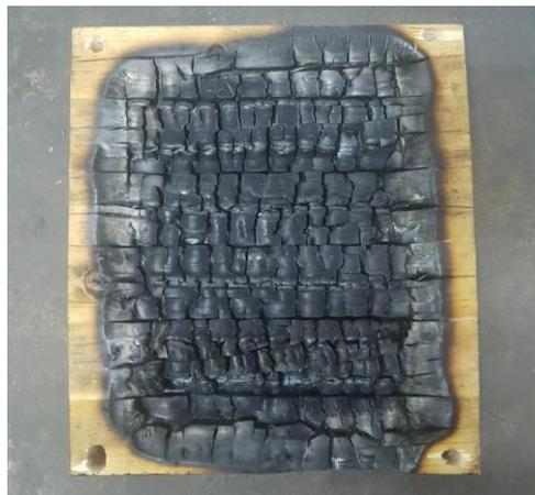
*Figura 49. Probeta carbonizada posterior a su apagado*
