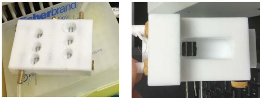
Figura 14-. Celdas de teflón utilizadas para preparar vesículas gigantes.
