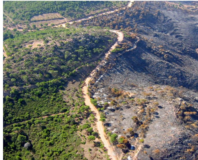
**Fig 51.-** Área cortafuego apoyada a la vialidad. Fuente: Departamento de Obras y Proyectos Generalitat Valenciana (2015) [Fotografía digital] Rescatado de: <http://www.agroambient.gva.es/documents/162905929/163206728/NT+%C3%81reas+cortafuegos+%2810%2C1Mb%29/c23b3dd0-3381-4e08-bde8-6f1a96f48171>
