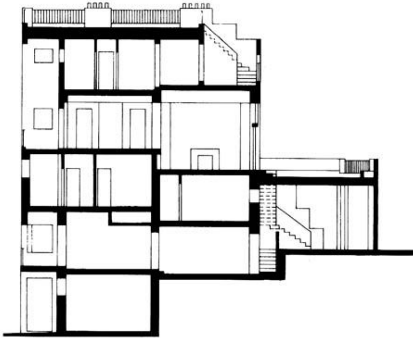
Figura 4.3: Corte de la Casa de Tristan Tzara. Arquitecto: Adolf Loos. Fuente: pinterest.com
