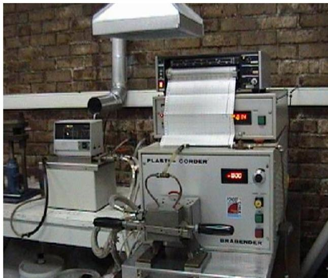
**Figura 14.** Mezclador discontinuo Brabender-Plasticorder
