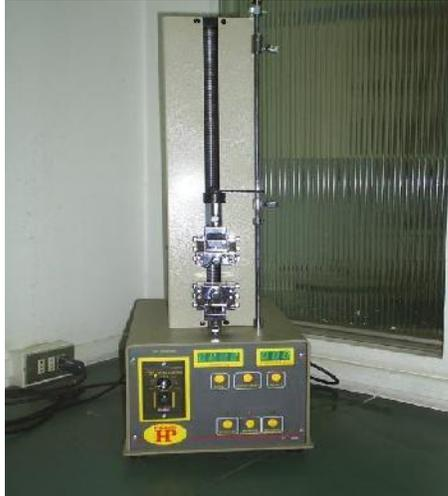
**Figura 20.** Dinamómetro utilizado en los ensayos de esfuerzo-deformación.
