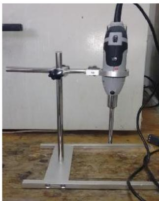
**Figura 21.** Homogeneizador tipo Ultraturrax.
