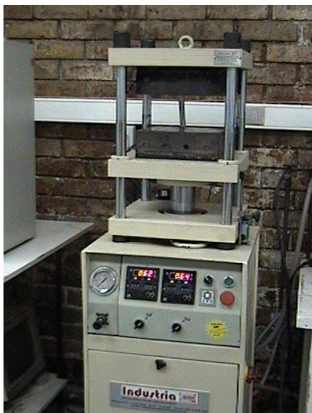
**Figura 15.** Prensa hidráulica empleada en la preparación de las películas poliméricas.
