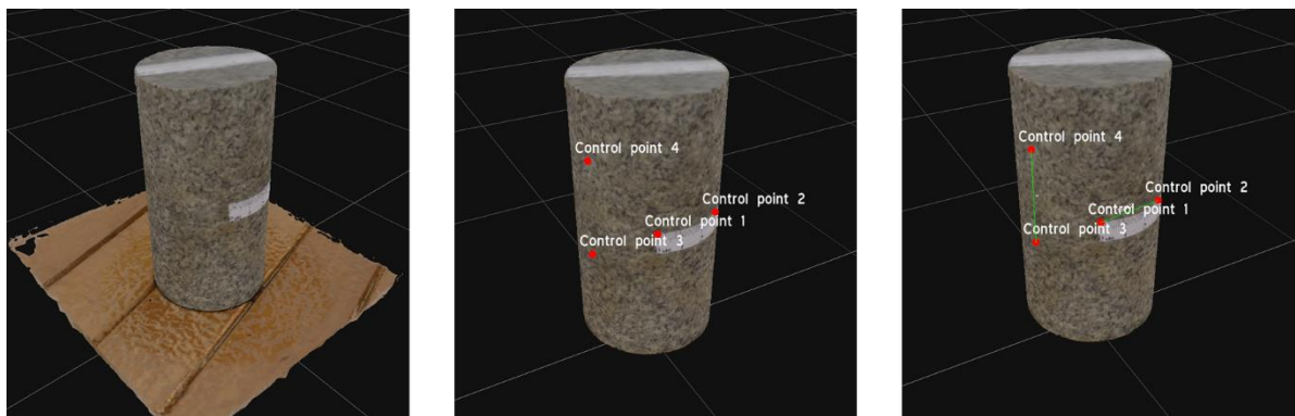
Figura 4.21: Trabajo en modelo de cilindro, remoción de mesa de apoyo, toma de puntos de control y medición de distancias respectivamente.
