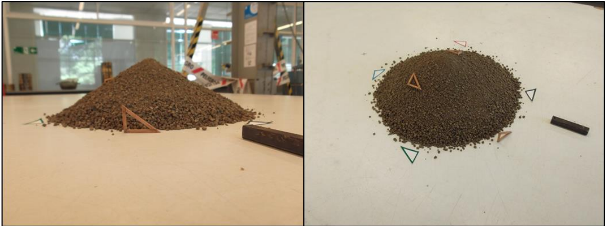
Figura 4.4: Tipo de fotografía antes de humedecer (A la izquierda fotografía horizontal, a la derecha fotografía con inclinación).
