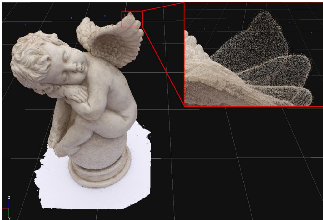
Figura 3.5: Generación de nube densa de puntos ( Close Range y Default ).
