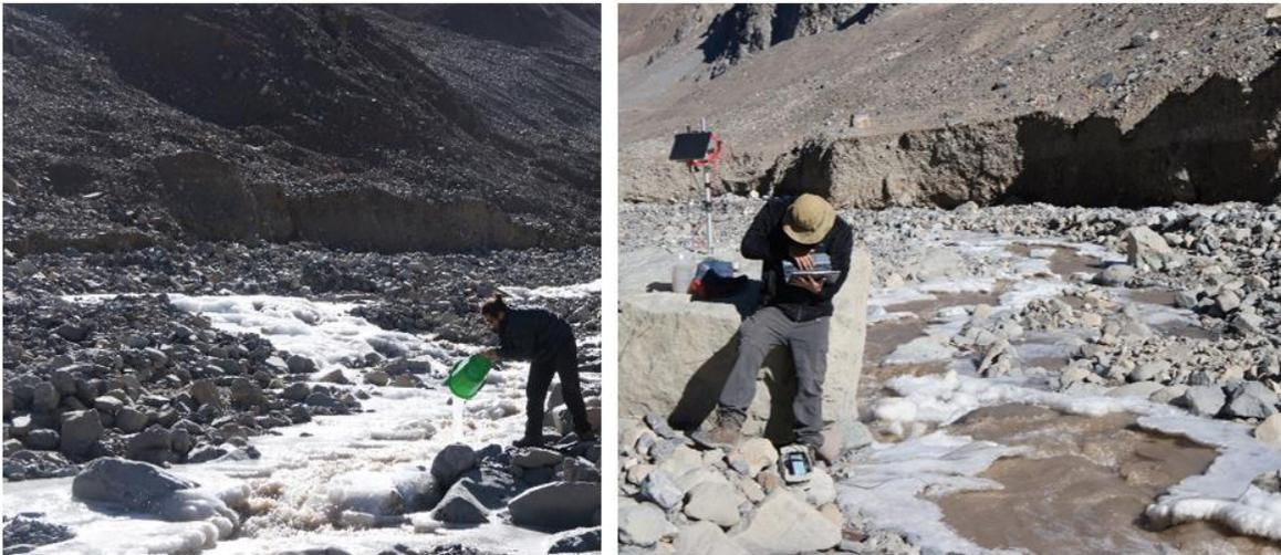
**Figura 8. 2 Fotografías de la realización de una medición de aforo. A la izquierda se presenta la inyección del trazador en solución en el río y a la izquierda la medición con el sensor correspondiente.**
