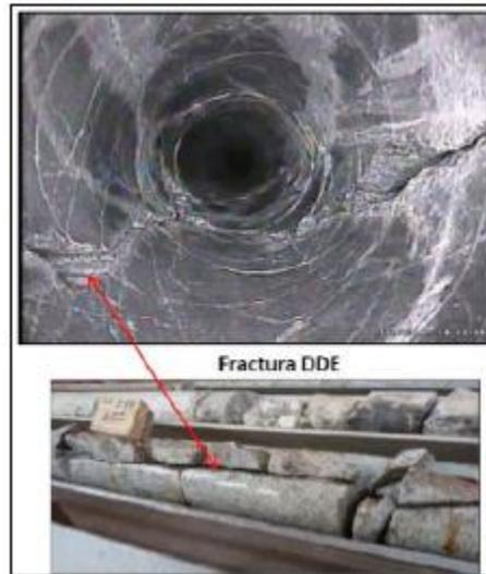
Figura 6: Fracturas generadas mediante DDE.
