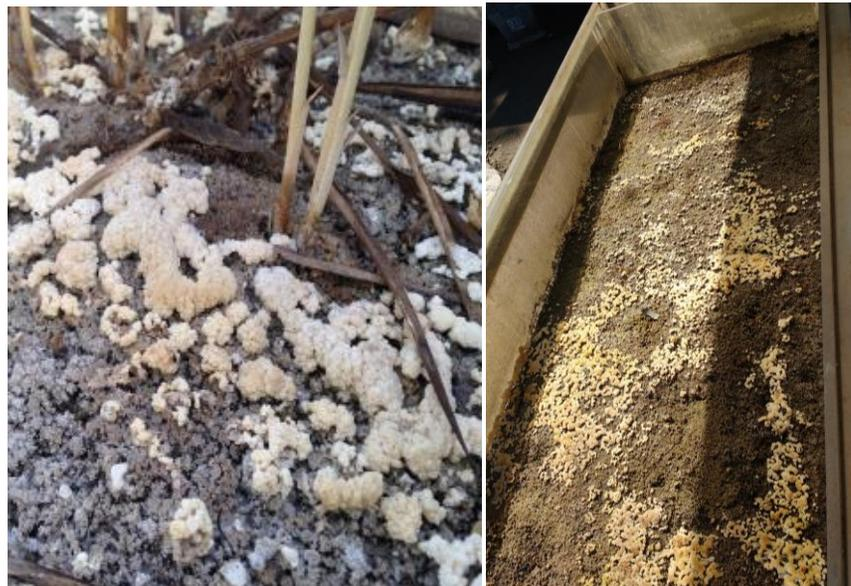
*Figura 4.19: Sólidos formados en la superficie de celdas con zeolita. Izquierda: Primer período de operación. Derecha: Segundo período de operación.*
