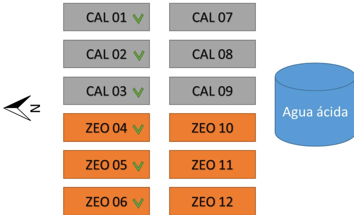
Figura 3.2: Distribución espacial de celdas en sistema de humedales, la “v” en verde indica presencia de vegetación.
