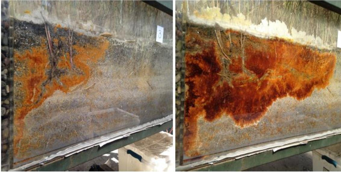
*Figura 4.16: Coloración presente en celda 3. Izquierda: Sistema con 46 días de operación. Derecha: Sistema con 150 días de operación. Fotos: Ignacio Jaque.*
