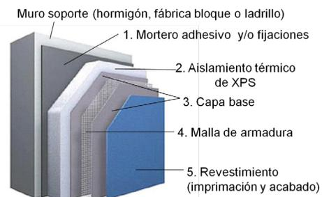
**Fig. 28 / 1.Unidades Constructivas / 2.Estructura principal / 3.Tabique Volcometal / 4.Sistema Aislamiento térmico exterior**
