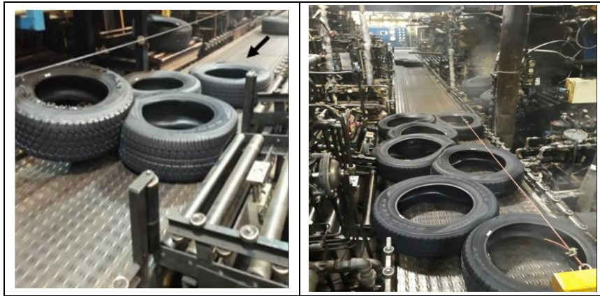
Figura 52. Atrapamiento de neumáticos.
