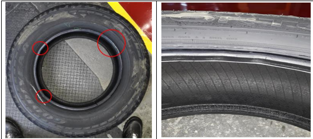
Figura 36. Daño en pestañas.
