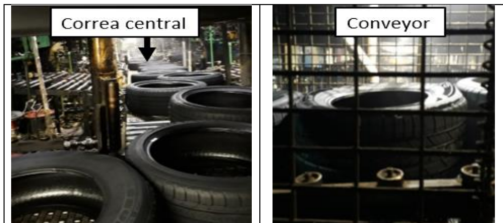
Figura 55. Congestión por interrupción de correas transportadoras.
