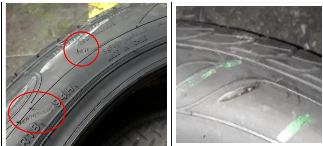
Figura 37. Daño en lateral.
