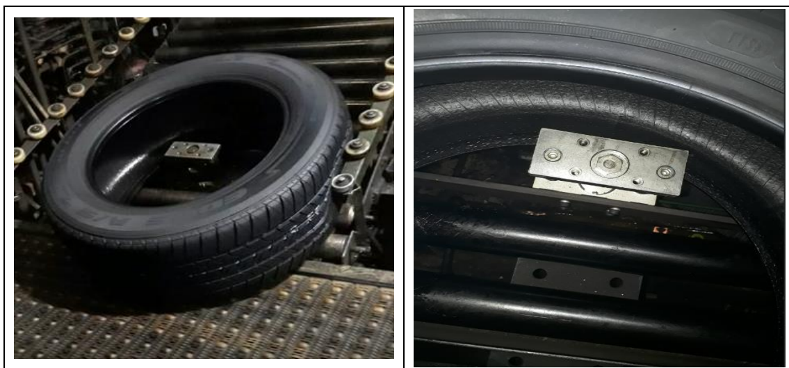
Figura 47. Neumático atrapado en compuerta.
