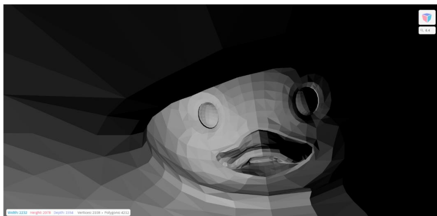
Figura 27 – Interior de un modelo con face culling activado, y dibujando el interior del modelo de manera independiente.
