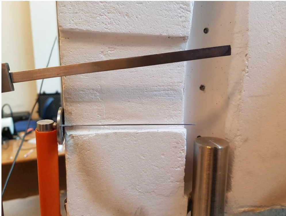
Figura 18. Montaje experimental IET en horno tubular vertical.
