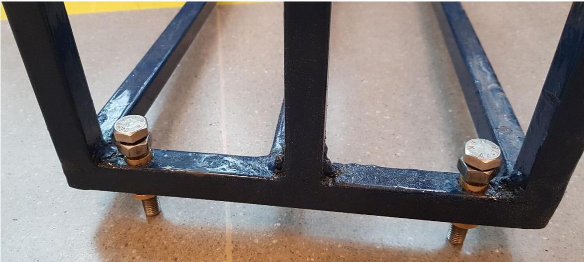
Figura 20. Ajuste de altura mesa de apoyo excitador.
