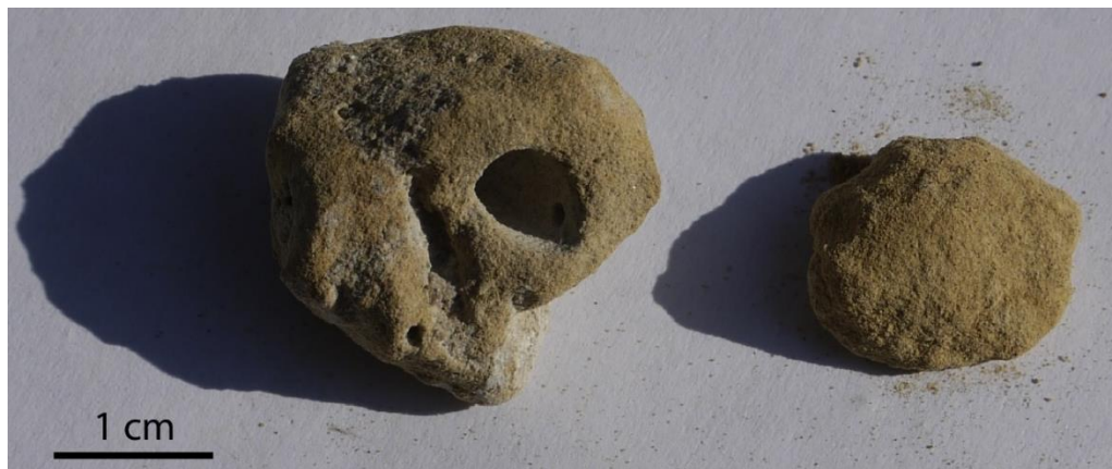
Figura 23. Imagen de la muestra Coq_06, en la que se observan dos fragmentos concrecionarios irregulares, color pardo amarillento, desarrollados en una matriz tamaño arena fina de composición arcósica.
