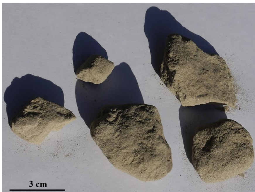
Figura 29. Imagen de la muestra Ho_02, en la que se observan distintos fragmentos concrecionarios de morfología irregular, color gris verdoso.
