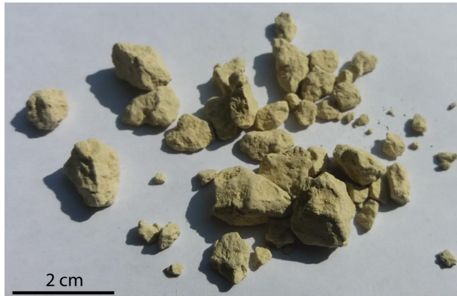
Figura 19. Imagen de la muestra Coq_04, en la que se aprecian fragmentos concrecionarios irregulares en una matriz tamaño limo grueso.
