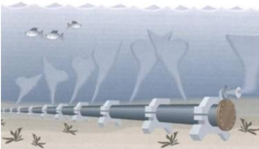
Figura 11.7 Sistema de descarga mediante difusor y emisarios subacuáticos.
