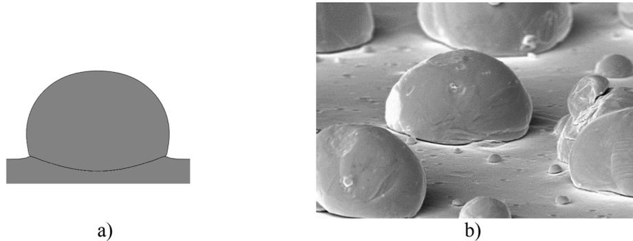
*Figura 6.35. Comparación de impactos titanio sobre titanio a 500 [m/s]; a) simulación con su gradiente de temperatura y b) fotografía de experimento.*
