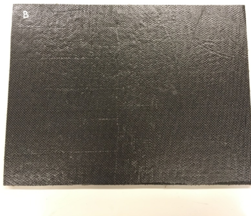
Figura 2.3: Panel tipo sandwich de fibra de carbono.
