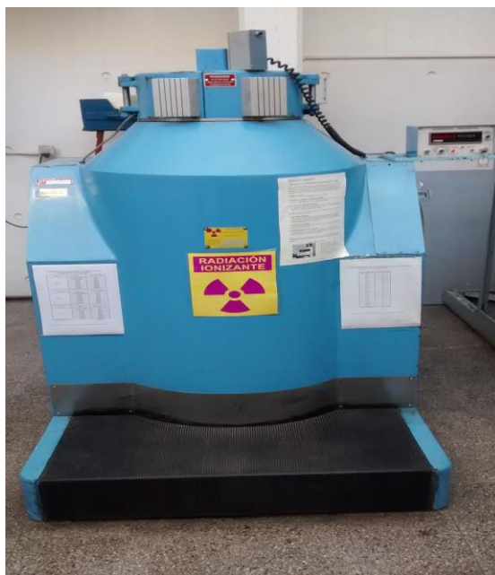
Figura 1. Irradiador experimental de ^{60}\text{Co} Gammacell 220-R.
