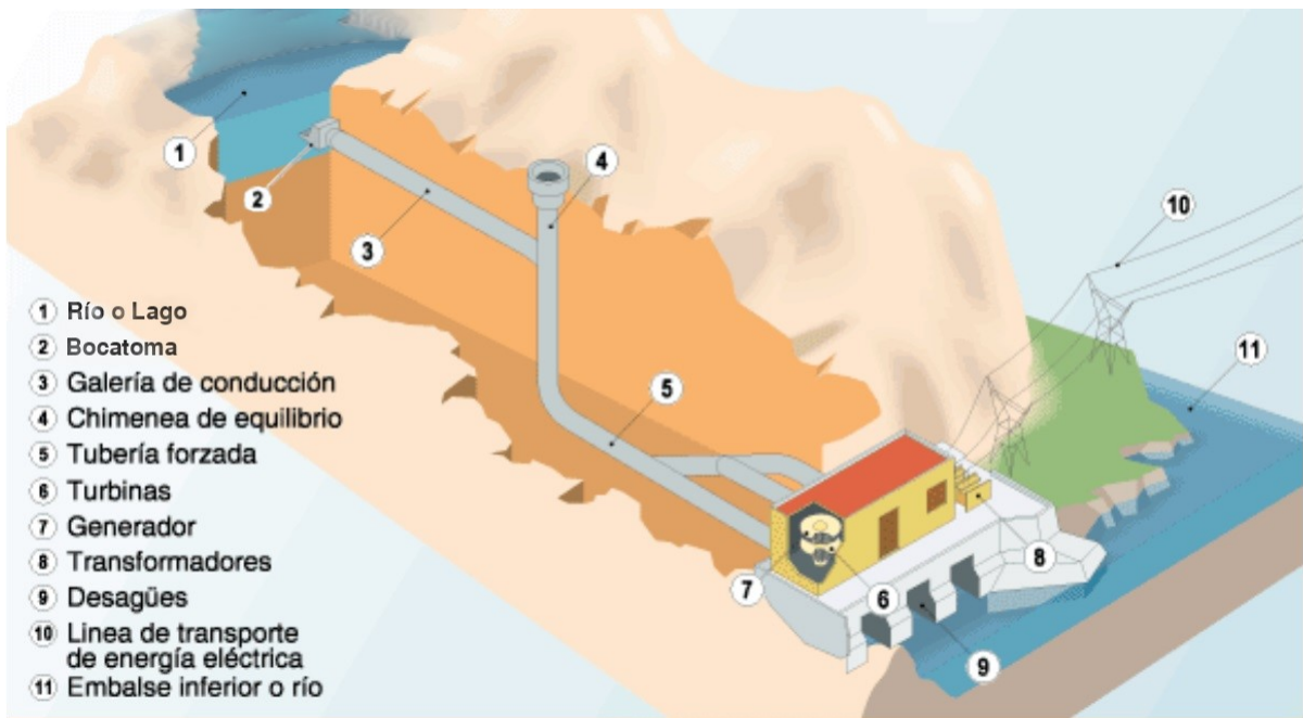
Figura 2.1: Esquema general de una Central de Pasada (Asociación Española de la Industria Eléctrica, UNESA).
