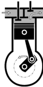
**Figura 2-3 Diagrama de funcionamiento de un compresor reciprocante.**
