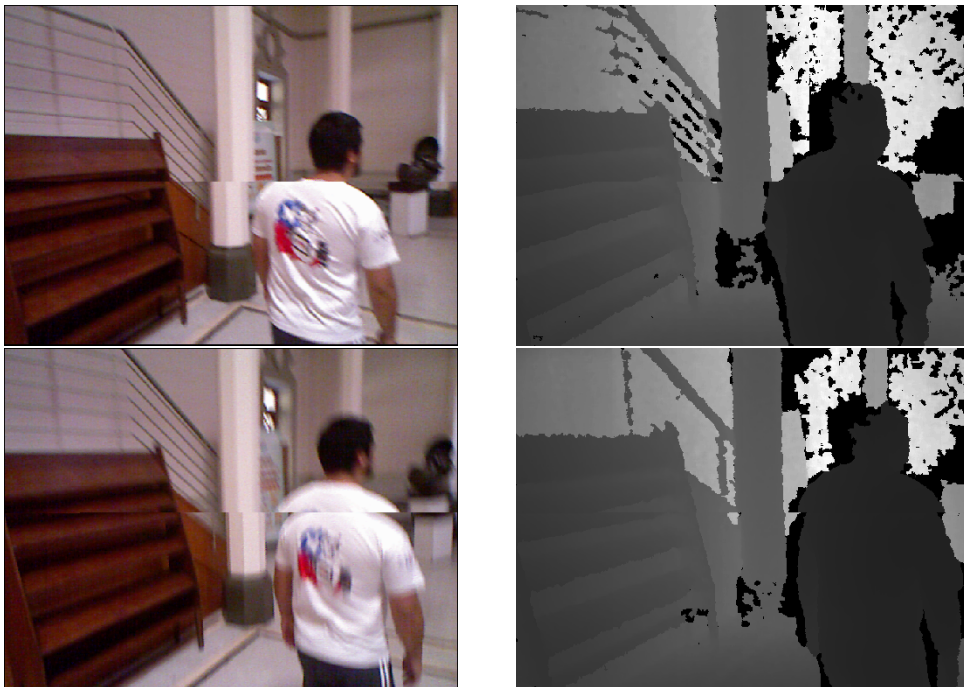
Figura 4.5: Distorsiones en la imagen por movimiento rápido del robot. Dificulta la detección del objetivo.
