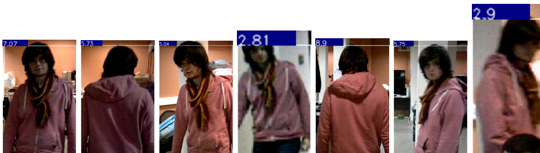
Figura 3.7: Imágenes de una misma persona en diferentes frames , dependiendo de las poses del robot y del objetivo. El número en la esquina superior izquierda indica la confianza entregada por el detector de personas.
