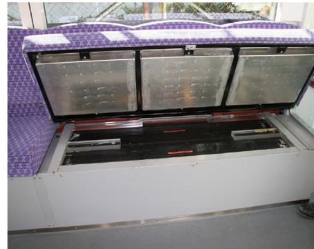
Figura 3.6: Módulo de baterías Gigacell bajo un asiento del tren SWIMO
