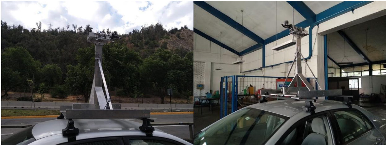
Figura 7.8. Banco de pruebas instalado sobre el automóvil. Elaboración propia
