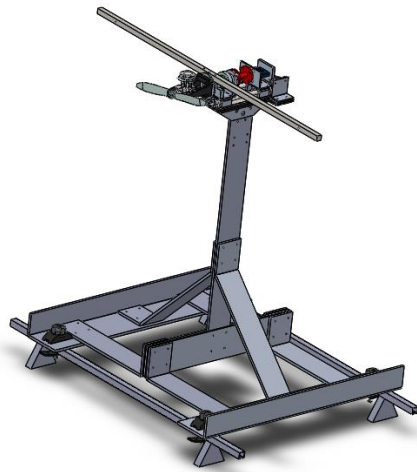
Figura 5.6. Sistema de calibración de celda de carga de torque. Elaboración propia
