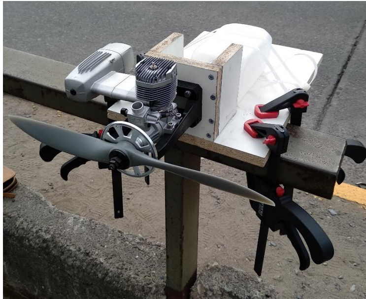
Figura 7.1. Instalación de rodaje del motor. Elaboración propia
