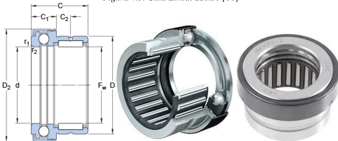
Figura 4.4. Rodamiento combinado NKX30 Z [19]
