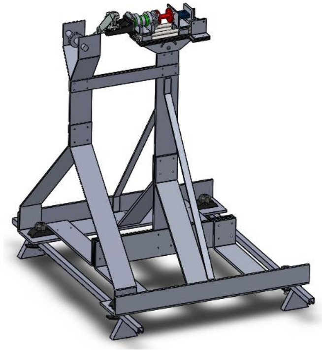
Figura 5.5. Sistema de calibración celda de empuje, elaboración propia
