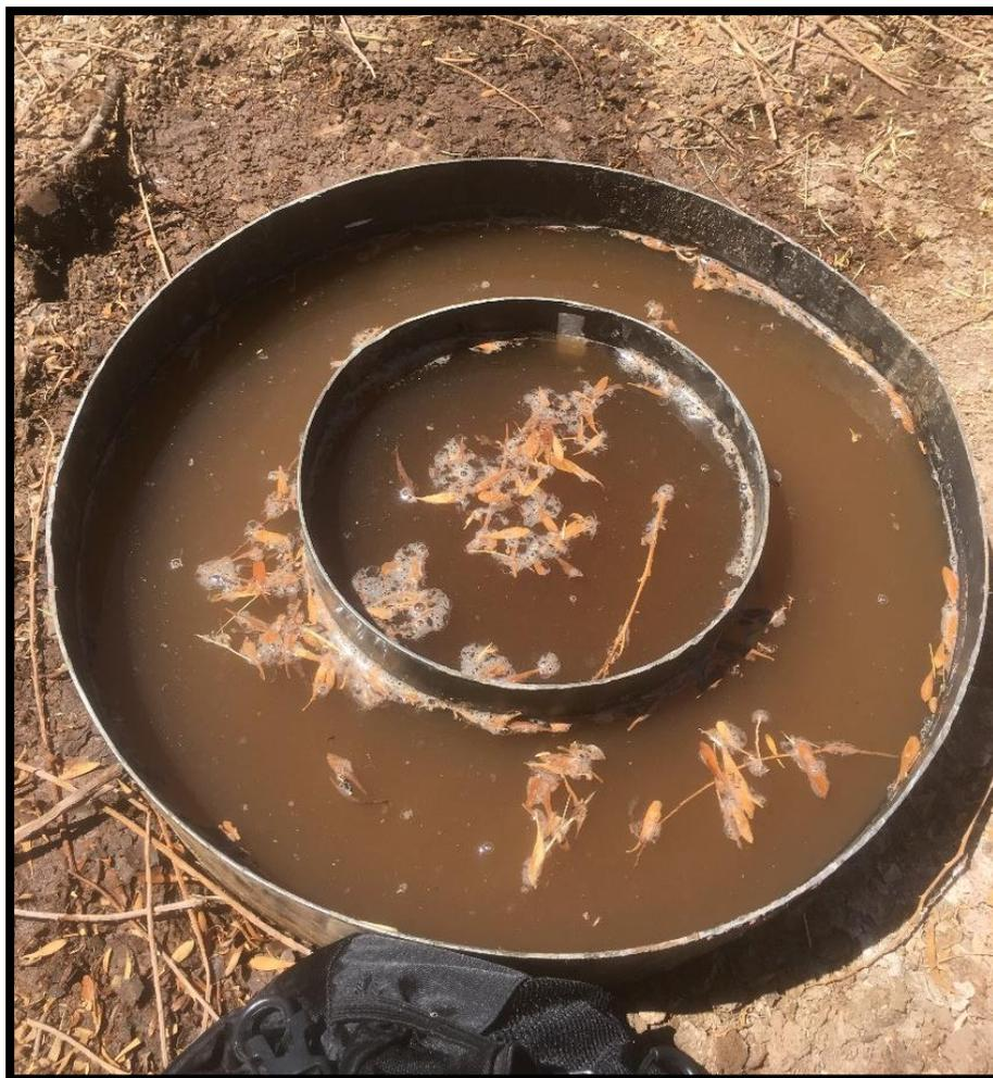
**Figura 5.16 Fotografía del montaje en terreno de uno de los ensayos de infiltración de doble anillo. Fuente: Elaboración propia.**
