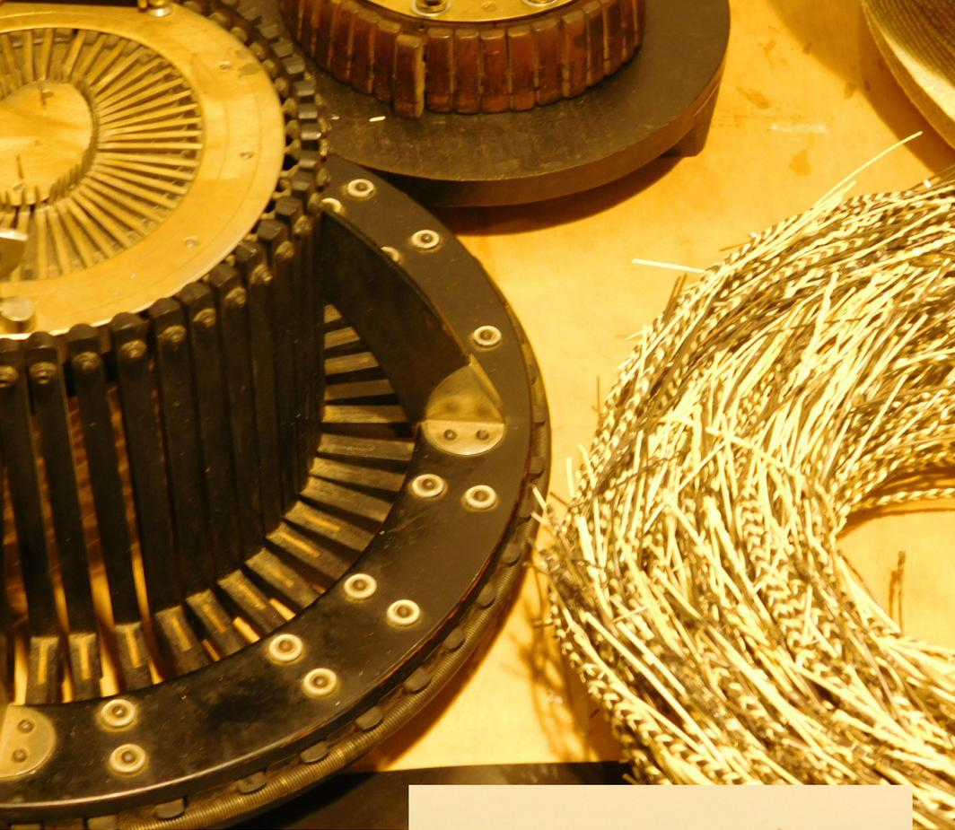
La conformadora se debe colocar como si fuera un sombrero, sus distintas piezas de madera se desplazarán según la forma de la cabeza, confeccionando un molde. Posteriormente éste será puesto en un formillón que permitirá al artesano elaborar la famosa Chupalla de Ninhue a medida.
