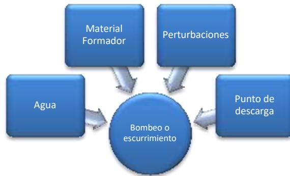
**Figura 6: Elementos para un escurrimiento o bombeo de agua barro.**
