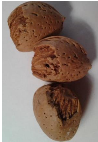
Figura 5.19: Resultado de muestras de almendras de cáscara dura ensayadas mediante prueba de impacto Charpy.
