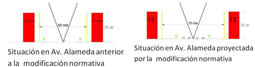
Imagen 75, 76, 77 y 78. Corte en calle y altura de edificación antes y posterior al cambio normativo. Fuente: Elaboración propia.
